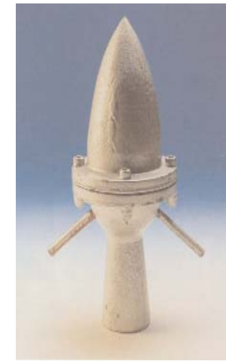
Die Kegeldüse, der erste Rake- tenantrieb für Flüssigtreibstoff.
